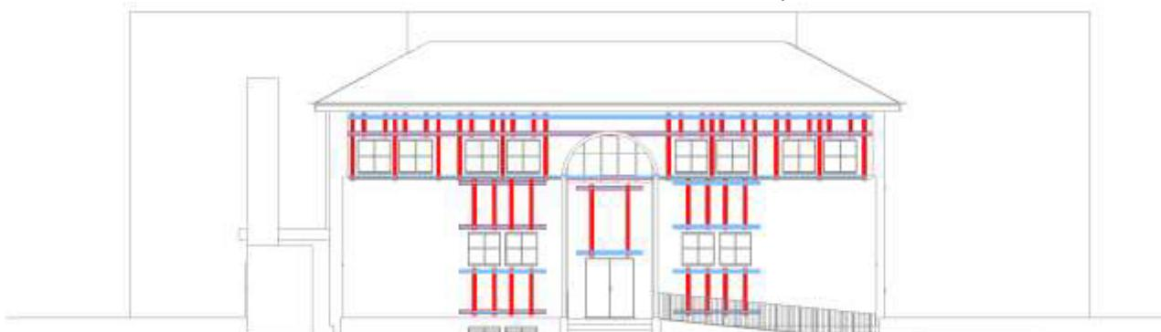
3. Interventi volti a ridurre le carenze dei collegamenti (C8A.5.1) mediante la realizzazione di un cordolo sommitale in c.a. opportunamente ammorsato alla muratura sottostante mediante delle barre filettate in acciaio inox;
