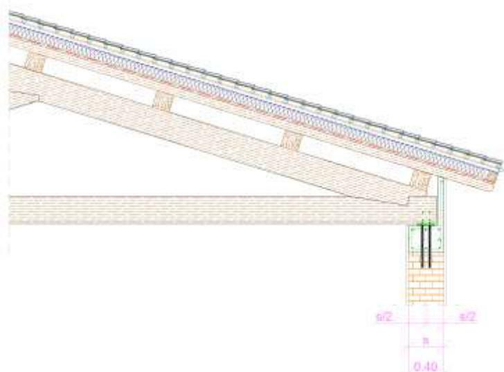
4. Riduzione delle vulnerabilità in copertura attraverso la sostituzione integrale delle fatiscenti strutture lignee esistenti con un più moderno tetto ventilato in legno lamellare;
